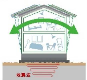
建物の強度を上げる地震対策ですが、建物が地震エネルギーを全て受け止めて耐えようとするため、構造全体へのダメージが大きく、余震や別の地震の際に本来の性能を発揮できない可能性があります。
