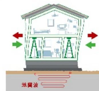
地震エネルギーを吸収するシステムです。建物の揺れが抑えられるため、構造基体へのダメージが軽減されます。
